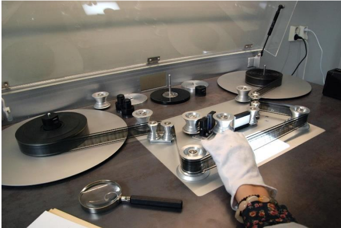
57. Filmi tehniline kontroll kerimislaual. Foto: K.Sikka
