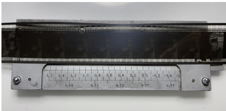
60. Perforatsiooni kokkutõmbeastme mõõtmine mõõtejoonlauaga.
