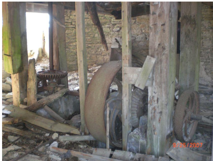
Foto 12. Vaimõisa tuuleveskis olev mehhanism. Allikas: I. Maar, erakogu .
