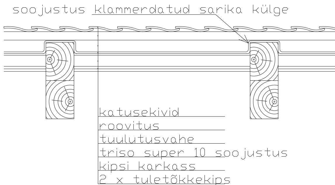
Joonis 1 Katusealuse soojustuse sõlm
