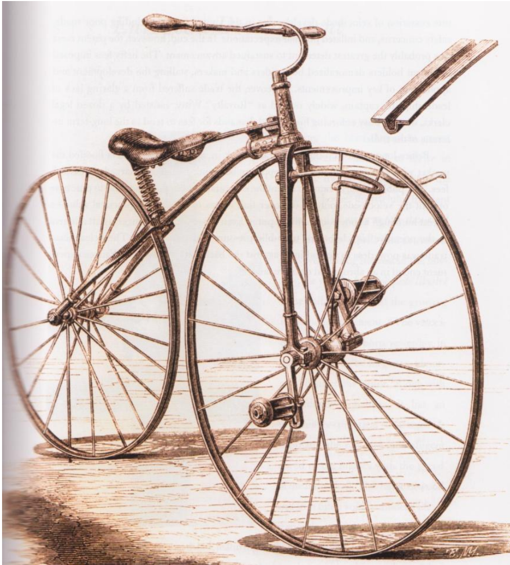
17. Niisugune joonis ilmus Scientific American ’is 12 juunil 1869. aastal. Virgil Price patenteeris kodaratega jooksud. Kodaratega jooksud on pandud edasi arendatud disainiga Pickeringi raamile. Kodaratega jooksud oli oluline edasi arendus, kui jalgratta hullus Ameerikas hakkas vaibuma, samuti on näha U-kujulist põida, kuhu on võimalik peale panna kumm.
