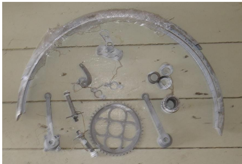
28. Komponentid pärast galvanikat, kus eemaldati vana kroom ja rooste. Foto: Ott Allan Mahlapuu
