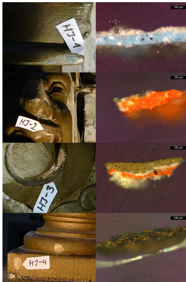
7. Mikrolihvid HJ-1 – HJ-4. Vasakul värviproovide asukohad, paremal neile vastavad mikrolihvid.
