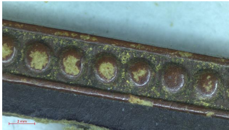
12. Valgusmikroskoobi foto, millel on näha katteklaasi ehisribal olevat punakat boluse kihti, mehaanilise hõõrdumise jälgi ning aja jooksul tekkinud tumedat krobelist kihti.
