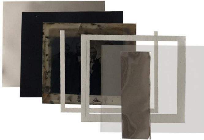
24. Sisepaketi kihtide asetumine üksteise peale, alumisest kihist alustades: MarvelSeal, must taustapaber, ambrotüüp, kartongraam, raamikujuline eralduskiht, õhuke kattedklaas, alumiiniumteip servadesse.
