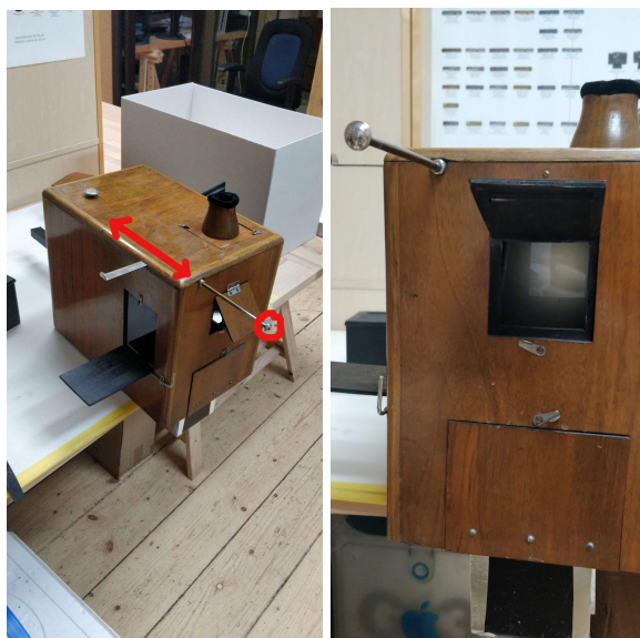
6. Mattklaas ja seda liigutav varras. (Prantsusmaal tööstuslikult toodetud kiirpildiaparaat TLM 19868 KF 399)
