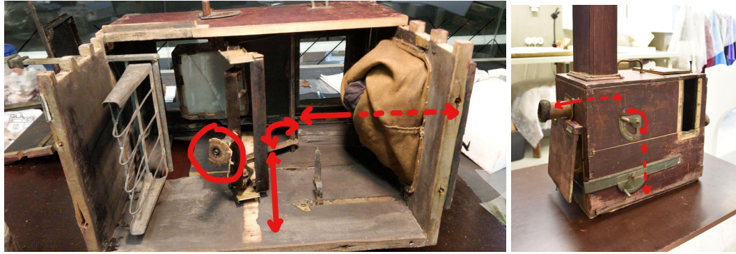
14. Klaasnegatiivi transpordi jaoks mõeldud mehhanism.
