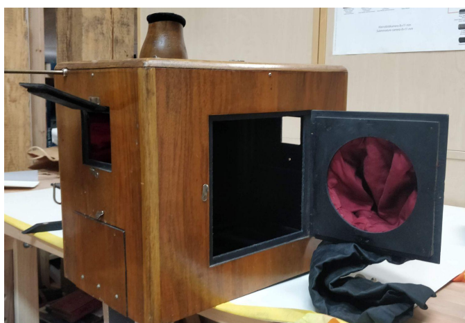
7. Tekstiilist varruka näide. (Prantsusmaal tööstuslikult toodetud kiirpildiaparaat TLM 19868 KF 399)
