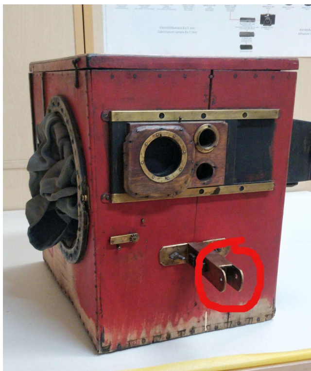
9. Kaamera ette kinnitatava toe liigend (Jaan Ennula kiirpildiaparaat TLM 23873 KF 543).
