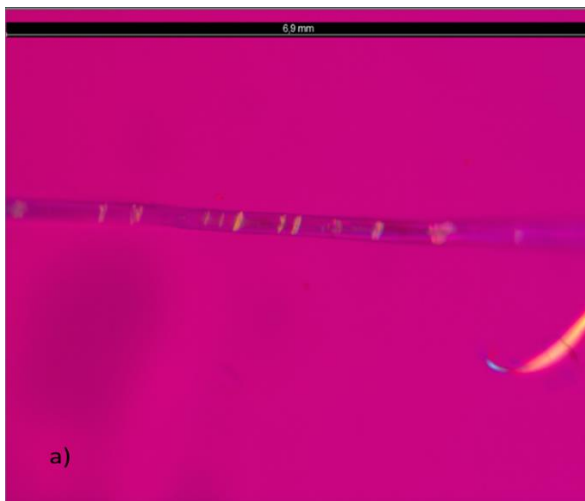
Joonis 52. Kontrolltest lina elementaarkiuga. A) Elementaarkiud on analüsaatori suhtes 0^\circ nurga all värvunud sinakaks. B) 90^\circ nurga all on elementaarkiud värvunud punakaks.
