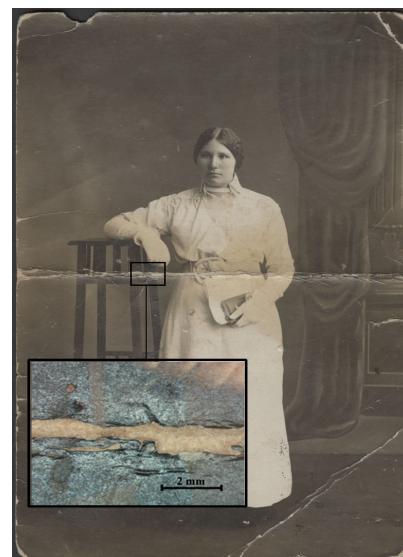
ill 21 Murdejoon. Fotot läbib murdejoon, suurendusel on näha purunenud emulsiooni- ja barüüdikiht.
