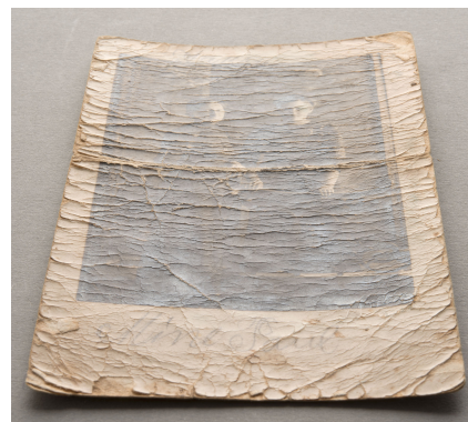
Ill 20 Foto kaardumine. Foto on kaardunud niiskuse toimel emulsiooni poole. Foto pinnal on näha pragunenud barüüdikiht, mis on tõenäoliselt purunenud foto rullimisel.
