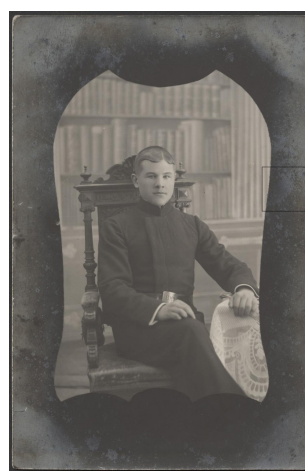
Ill 24 Hõbepeegel. Hõbepeegel on tekkinud foto äärealadele, heledad toonid foto keskel on kahjustamata. Ümarad peegliälad viitavad selle, et fotot on palju nurkadest ja äärtest paljaste kätega katsutud. Paremäl suurendus sõrmejäljest.
