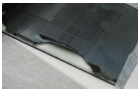
37. Klaaspõhimikult irduv emulsioonikiht (5631/1691)
