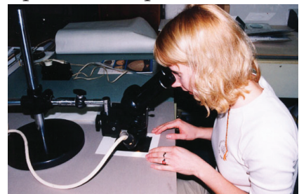
41. Väikese autokroomplaadi kahjustusi on hea uurida mikroskoobiga
