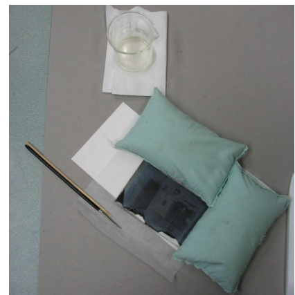
42. Töövahendid irdunud zelatiin-emulsiooni kinnitamiseks
