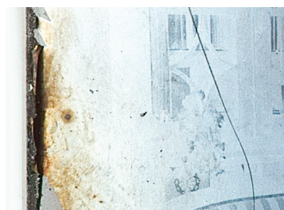
38. Plaadi servas tärgklisrastrist irduv želatiinemulsioon, selle pinda ühtlaselt kattev "hõbepeegli"-kiht ja kriimustused emulsiooni pinnal. (5631/1691)
