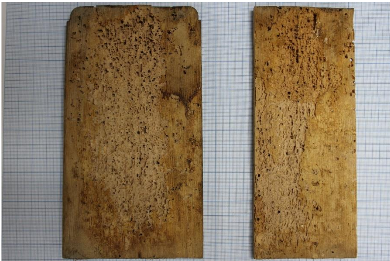
Irdetailide viimistluse kinnitamine, puhastamine ja putukate tekitatud kahjustused.
