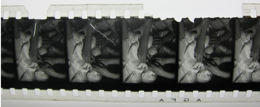
13. Perforatsiooni kahjustus, rebendid perforatsiooniaukude ümbruses.
