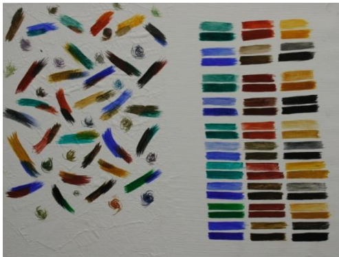
Ill 10: Retušeerimismediumide katse. Ülevalt alla – R. Gamblini konserveerimisvärvid; Mowilith 20; õlivärvid, akvarellid, lakivärvid.
