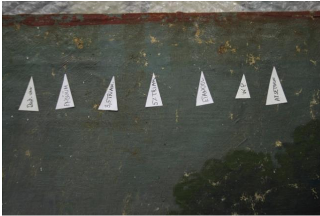
Ill 6: Puhastusproovid sobivaima lahuse leidmiseks: destilleeritud vesi, ensüüm, etanool, atsetoon, white spirit, 3,5% triammooniumtsitraadi vesilahus ja 5% triammooniumtsitraadi vesilahus.
