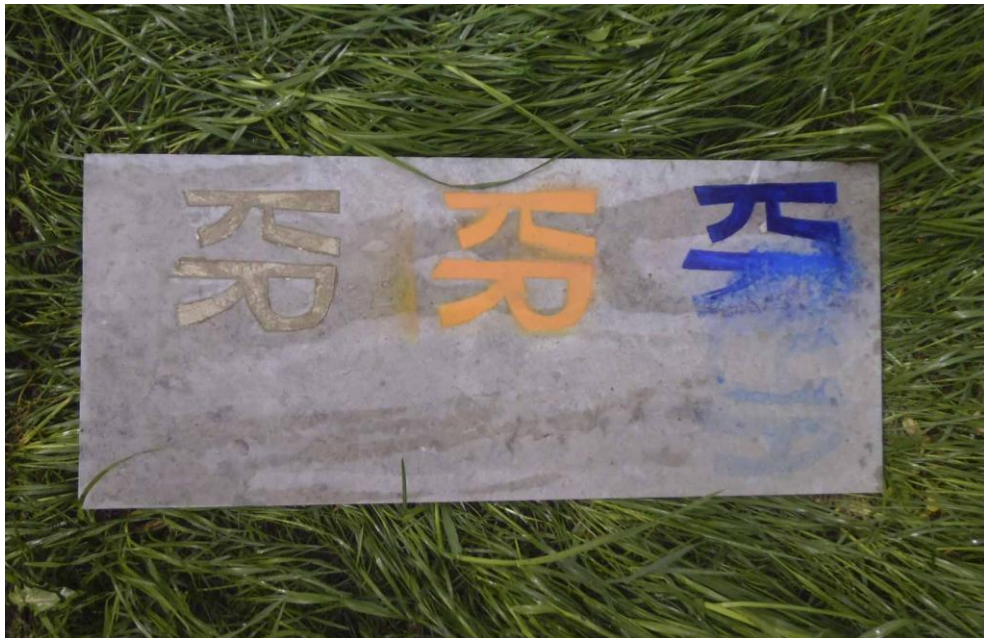
13. Paeplaat pärast varju eemaldusvahendi kasutamist – edukalt on eemaldatud nii emulsioon- kui ka aerosoolvärv. Veekindel marker on sügavale paeplaadi pooridesse imendunud ja selle eemaldamine on aeganõudev ning kulukas.
