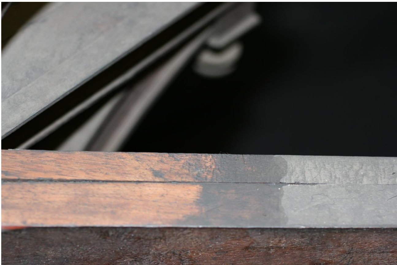
Puhastamine Shellsol T-ga. Vasakul puhastatud, paremal puhastamata pind.
