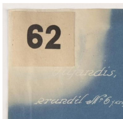
19. Aluselise liimist tekkinud värvimuutused tsüanotüübil (VM 9554:175/4a Ar).
