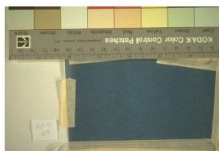
17. Sama tsüanotüübi näidis pärast nädalapikkust eksponeerimist 250 lux valgustugevusega konserveerimislaboris.
