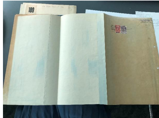
91. Kokkuvolditud tsüanotüübi välimine osa on tugevalt koltunud, mille põhjuseks on tõenäoliselt pikaajane kontakt happelise kiirkõitja kaanega (VM 9554:50/6 Ar).
