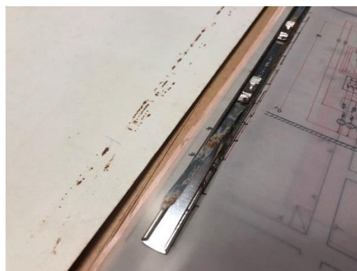
121. Roostes klambrid on tekitanud joonistele plekke.
