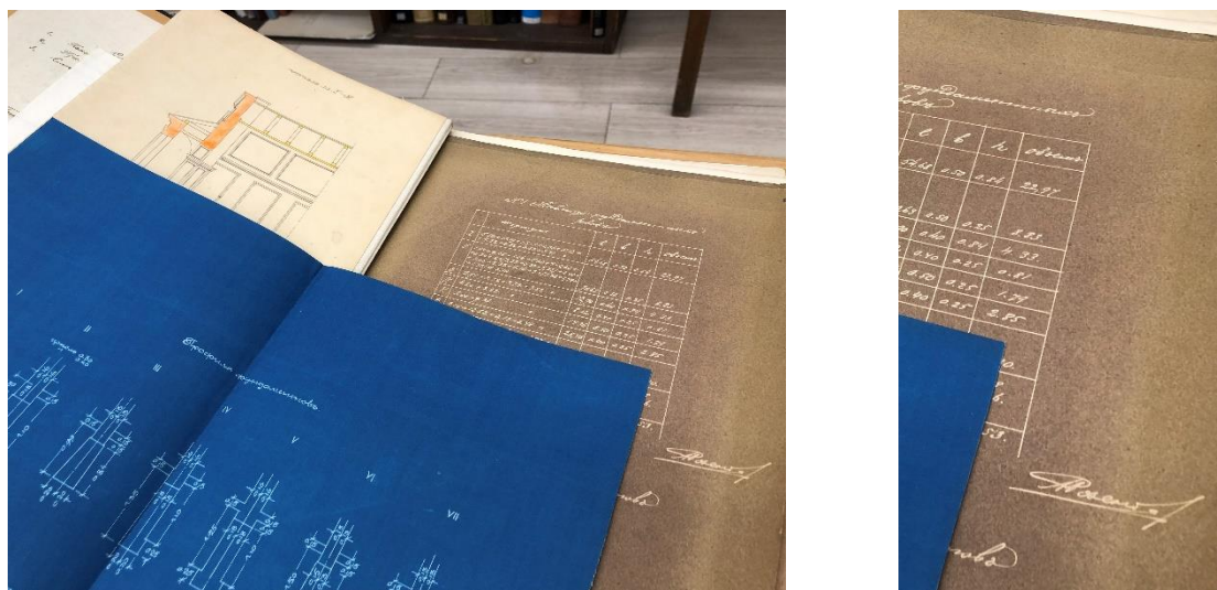
113., 114. Tsüanotüüp (TLA.149.6.124/3) ja vandyke'i – koopia (TLA.149.6.124/4) on olnud vahetus kontaktis. Vandyke'i kujutis on servades muutunud heledamaks.
