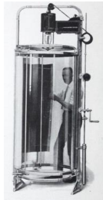
6. Originaaljoonis koos kopeerimispaperiga kinnitati silindrile spetsiaalse peale rullitava kattega (The C. F. Pease Company, 1928).
