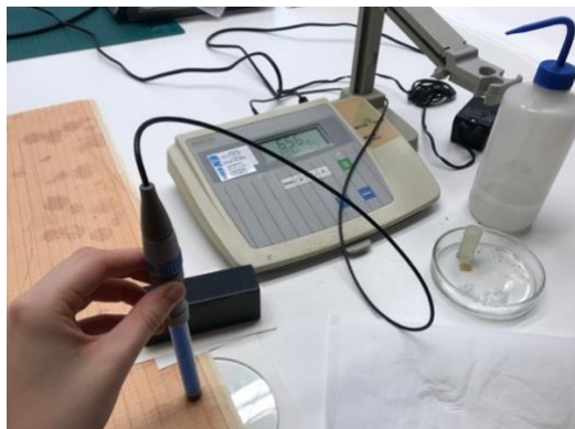
11. PH mõõtmine kontaktmeetodil (foto: Kadri Väljaots)
