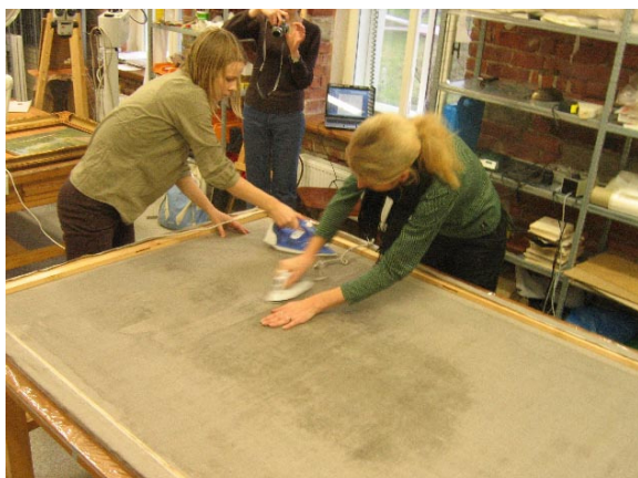
13. Dupleeringu soojendamine ning lõuendite kokkupressimine u 70°C triikrauaga maali tagaküljelt. Foto: Merike Kallas
