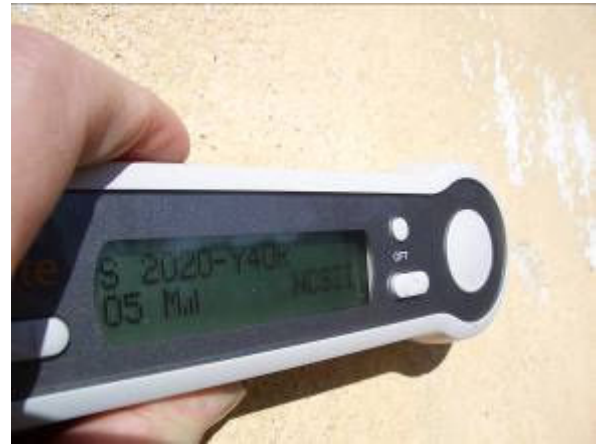
Joonis 4.34 Ärkli seinapinna mõõtmine spektrofotomeetriga Matchstick RM130AK15 abil, autori foto.
