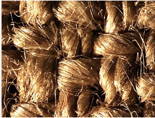
47./48. Naturaalne lõuend: karvastamata ja karvastatud. Suurendus x20. (Autori fotod).
