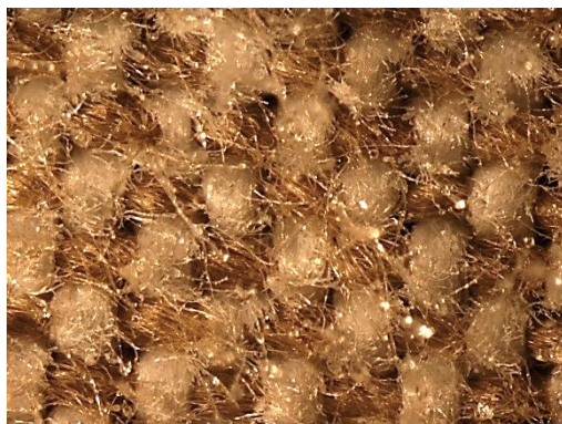
51./52. Liimiosakeste paigutumine sünteetilise (vasakul) ja naturaalse (paremal) lõuendi kiududele. Suurendus x20. (Autori fotod).
