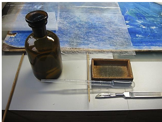
35./36. Pettenkoferi kastikese meetodi rakendamine liimi pehmemdamiseks. (Autori fotod).
