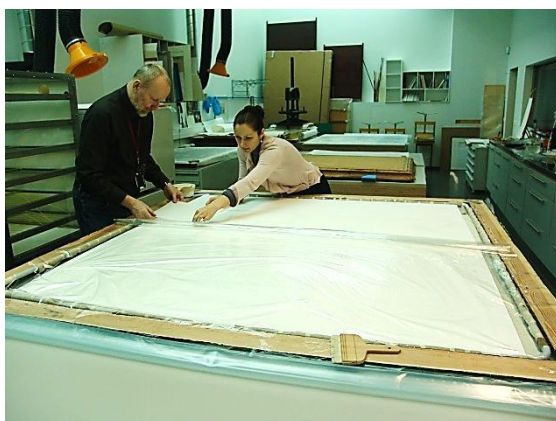
41./42. Keskmise osa kärgplaadile jaapani paberi kihi liimimine (foto: Margit Pajupuu); keskmine osa reguleeritud madalsurve suruõhu süsteemi pressis, jälgimine (foto: Alar Nurkse).
