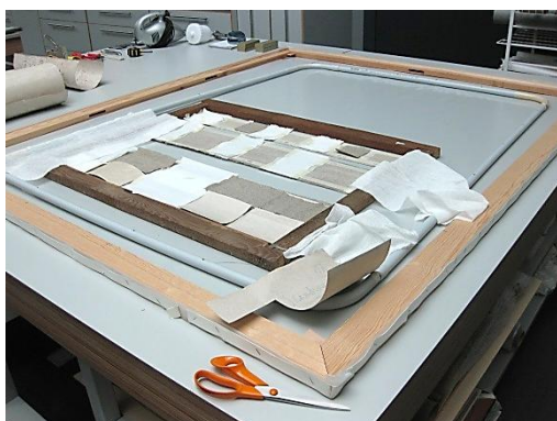
53./54. Taustatavate materjalide valimine udutaustamise katsetuseks. (Autori fotod).
