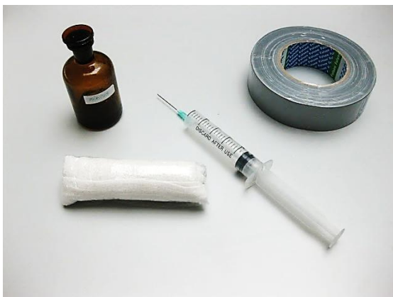
16./17. Kile sisse mähitud marlipakike ja etanooli süstimine sellesse kontrollitud niisutamiseks. (Autori fotod).
