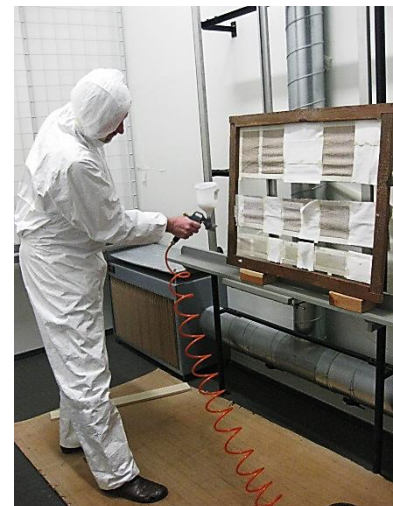
49./50. Liimi segamine ja pihustamine õhksurve-pihustiga. (Autori fotod).
