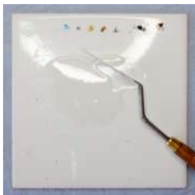
Joonis 38 vasakul, Epoksiidvaigu toonimine
