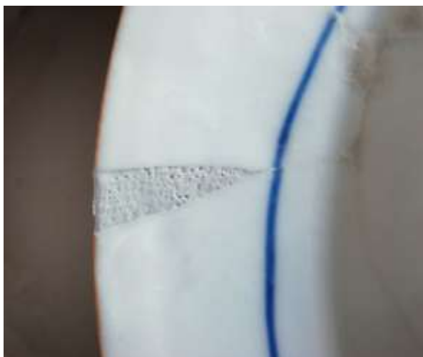
Joonis 26 vasakul, liiga suurest lahusti hulgast täites põhjustatud defektid, detail tööde käigus
