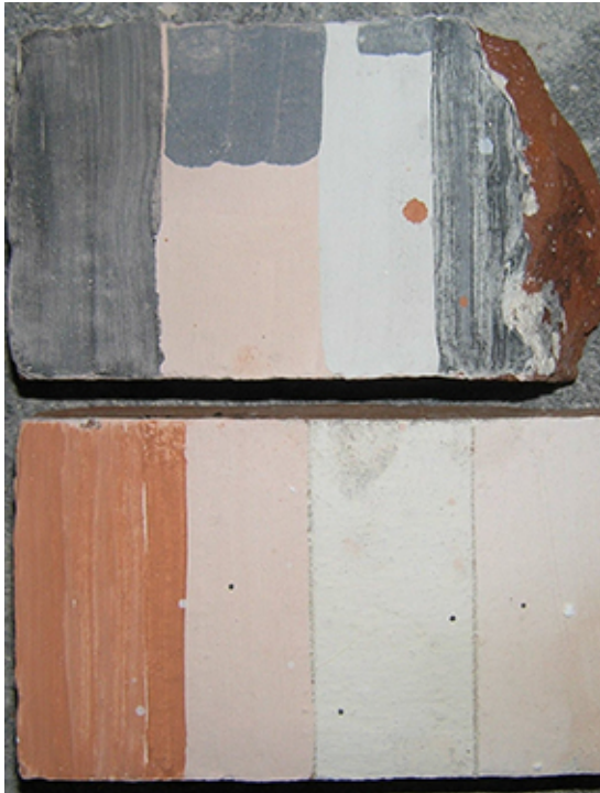
10. Proovilapid lubivärviga telliste katmisel.
