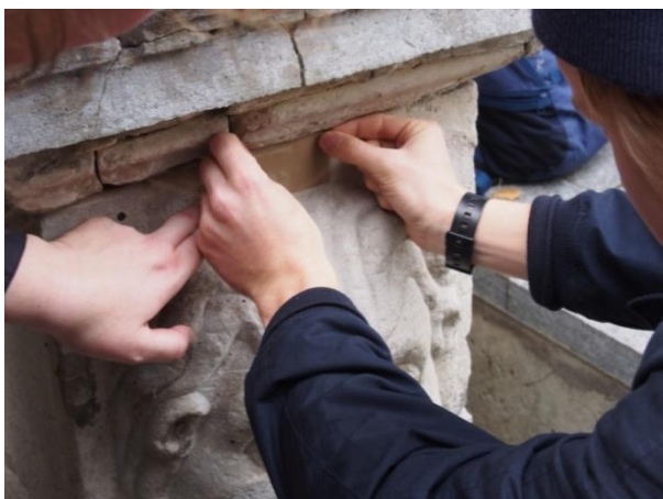
36. Eesti Kunstiakadeemia muinsuskaitse ja konserveerimise osakonna tudengid teostamas „scotch-tape“ testi selgitamiseks välja kivi konsolideerimisvajalikkust. 7. IX 2015.
