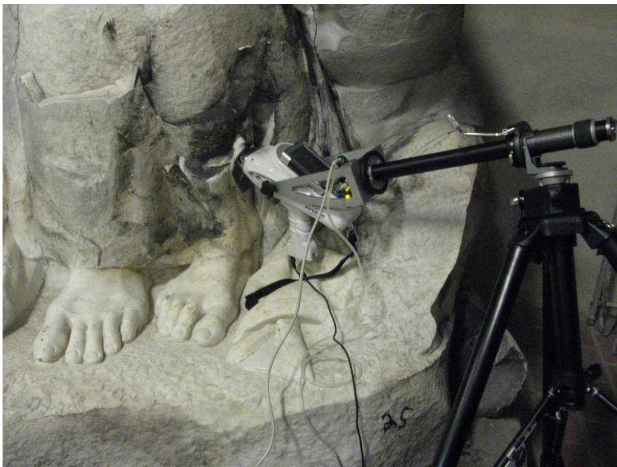
Foto 79: Tahmadeposiididel XRF analüüside teostamine TÕ arheoloogiaosakonna masinaga Bruker Tracer III-SD, 2015 sügis.
