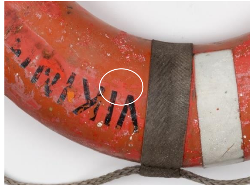
ill 16. Lähivaade päästerõngale pärast konserveerimistööd. Esile on toodud ala, kus värvikihi kinnitamine tuleb kõige paremini esile.
