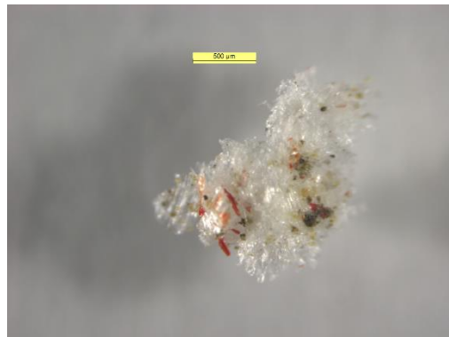
ill 6. päästerõnga sisust võetud proovitükk mikroskoobi vaatlusel 40x suurenduse all.
