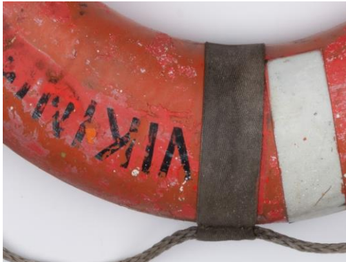
ill 15. Lähivaade päästerõngale enne konserveerimistööde teostamist selle Viking Sally-poolsele küljele, kus värv irdub ulatuslikumalt.
