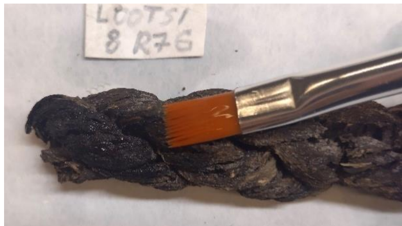
60. Haprad köied töödeldi 1% Klucel G tugevdava lahusega. Pildil köis R7G.
