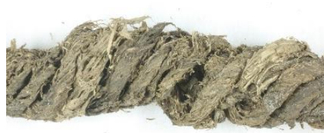
56–59. Köis R7F (ülevallt alla) enne ja pärast puhastamist, pärast atsetooniga kuivatamist ja lähivaade kiustruktuurist.
