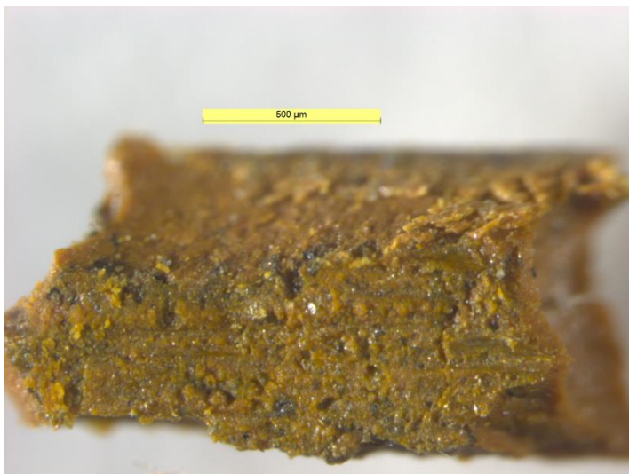
Joonis 3 Proovitükk L_SA_2 raamipoolse pinna suurendatud vaade. Seadistus: 4,0 x 10 x 2
