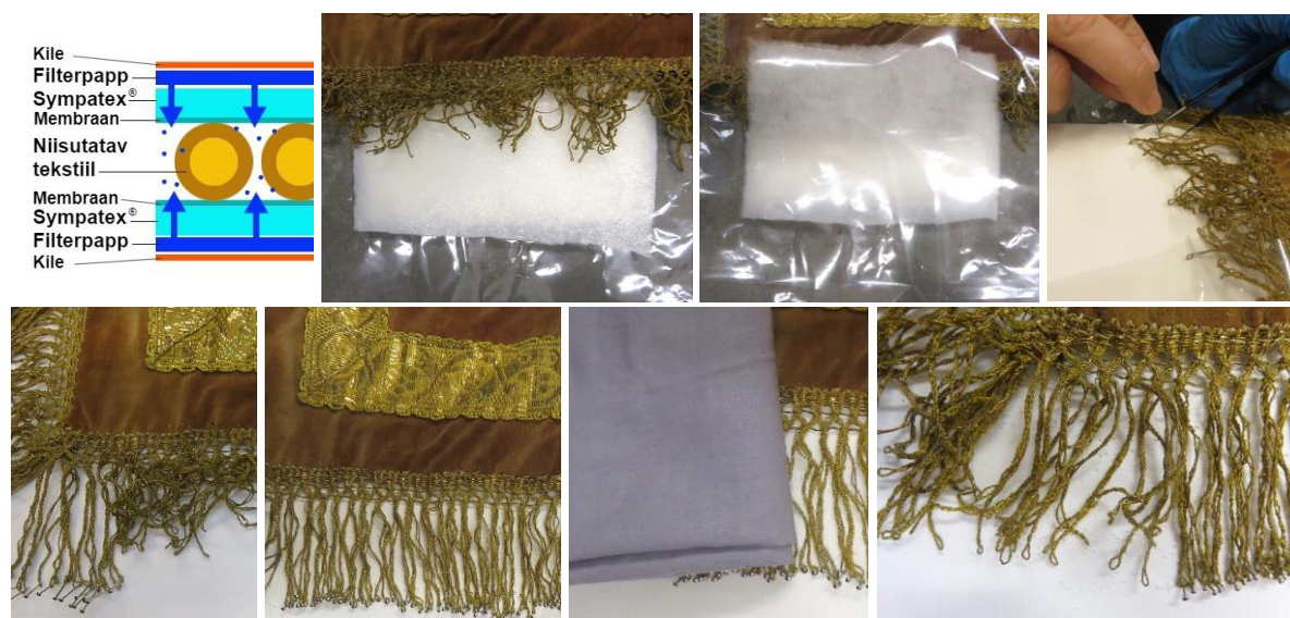
28. Kihiline niisutussüsteem nn “sandwich”, narmaste asetamine kihtide vahele, narmaste sirutamine.
